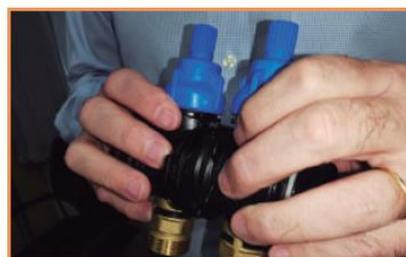
**1.** Seleccionar el modelo de colector. Unir los módulos, haciendo coincidir la parte macho de uno, con la parte hembra del otro.
