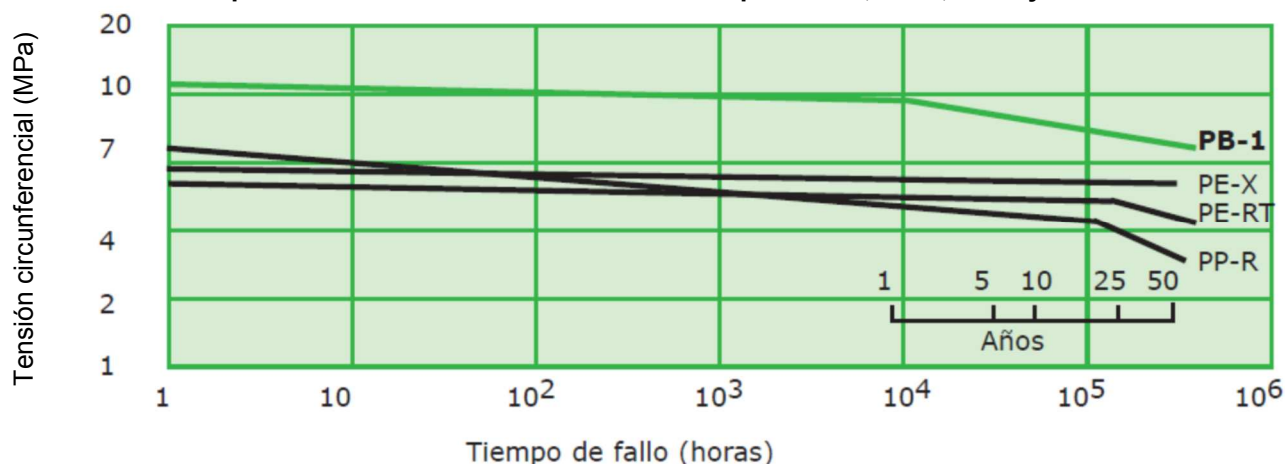
Comparación de líneas de referencia a 70 °C para PB-1, PE-X, PP-R y PE-RT
