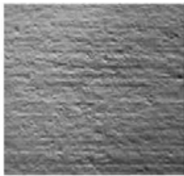
CSP 4 (Escarificado ligero)
