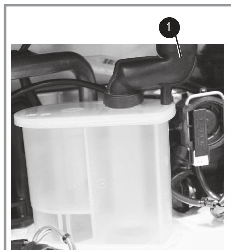
figura 44 - Tubo de goma de desagüe del colector
