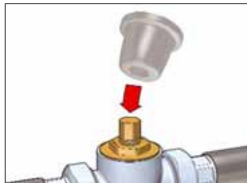
Uso de la tapa para regular la temperatura
