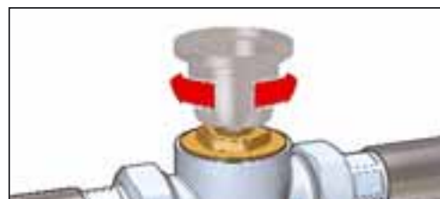
Tapa aplicada al tornillo de regulación de la temperatura
