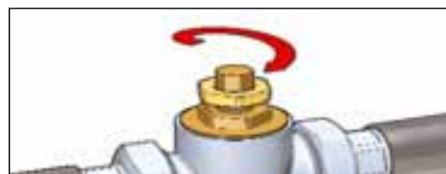
Bloqueo de la regulación con la tuerca
