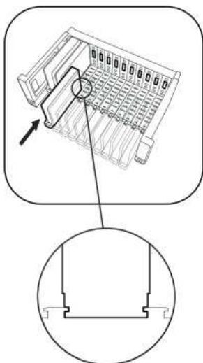
En el caso de procesar canales de TV encriptados, introducir las CAMs y tarjetas del operador en los módulos FLOW SEC.
