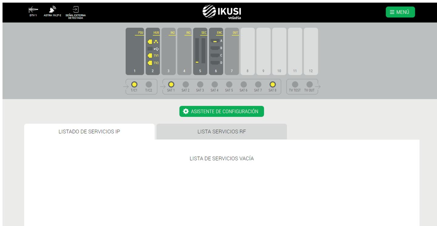
En el ejemplo, la franja superior informa de que se ha conectado un antena terrestre (identificada como DTV1), una antena parabólica apuntando al satélite Astra 19.2°E y se ha detectado señal RF en la instalación no generada por Ikusi Flow.
