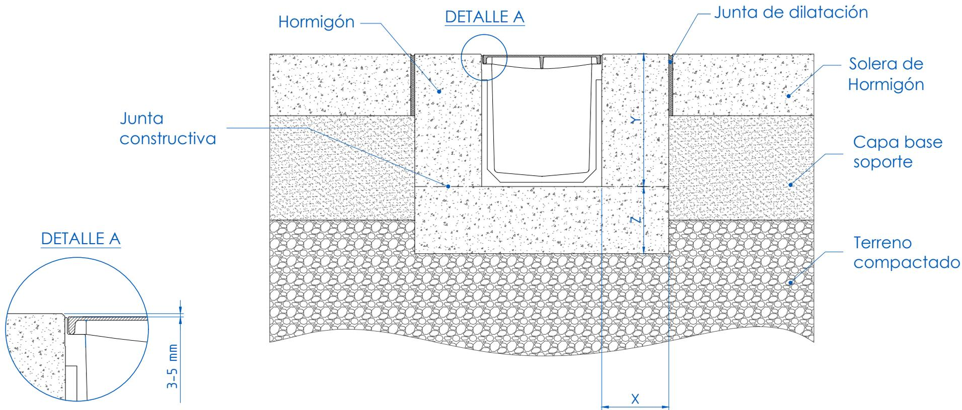
Para tráfico transversal intenso utilizar los canales KompaaqDrain
