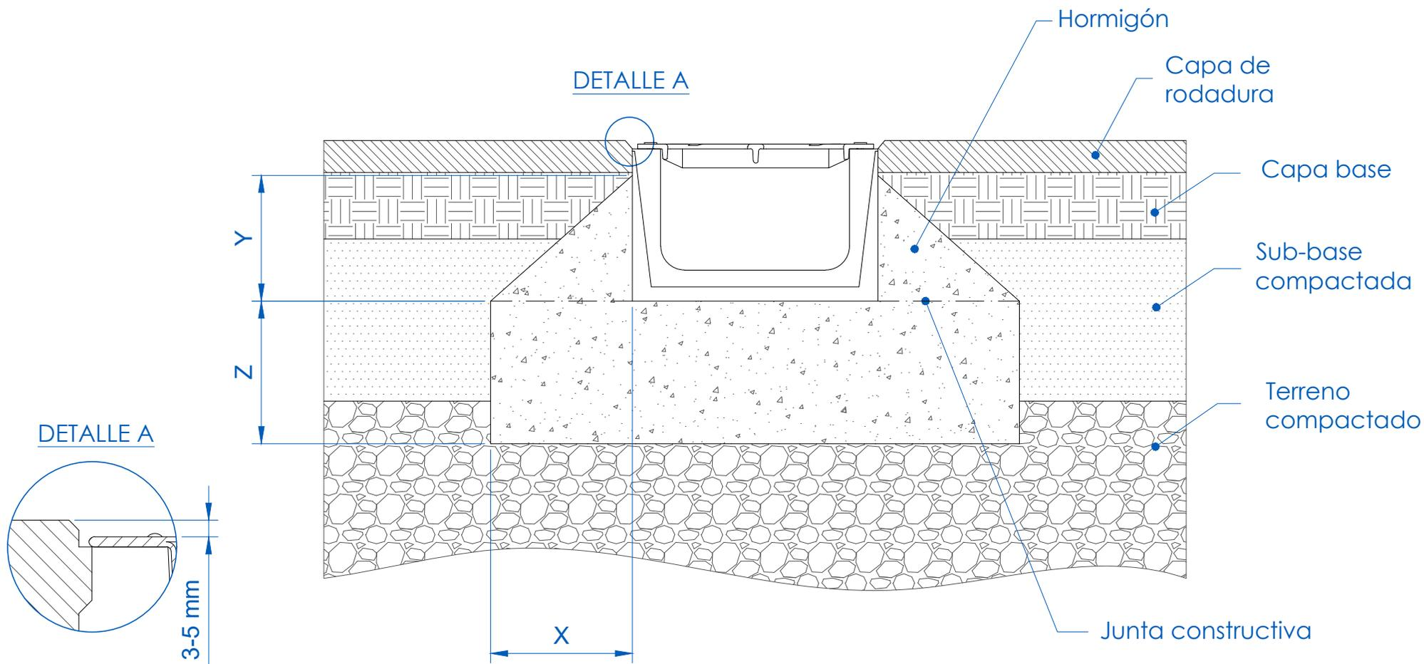
\* Si no existe un correcto compactado del terreno, realizar dado de hormigón hasta el nivel del pavimento.
