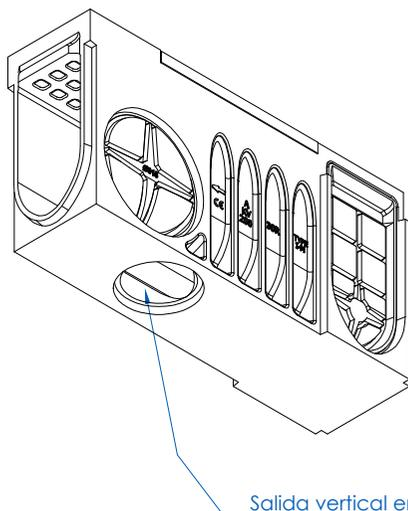
Ranura perimetral preformada para facilitar instalación de junta de sellado envolvente en 360°
