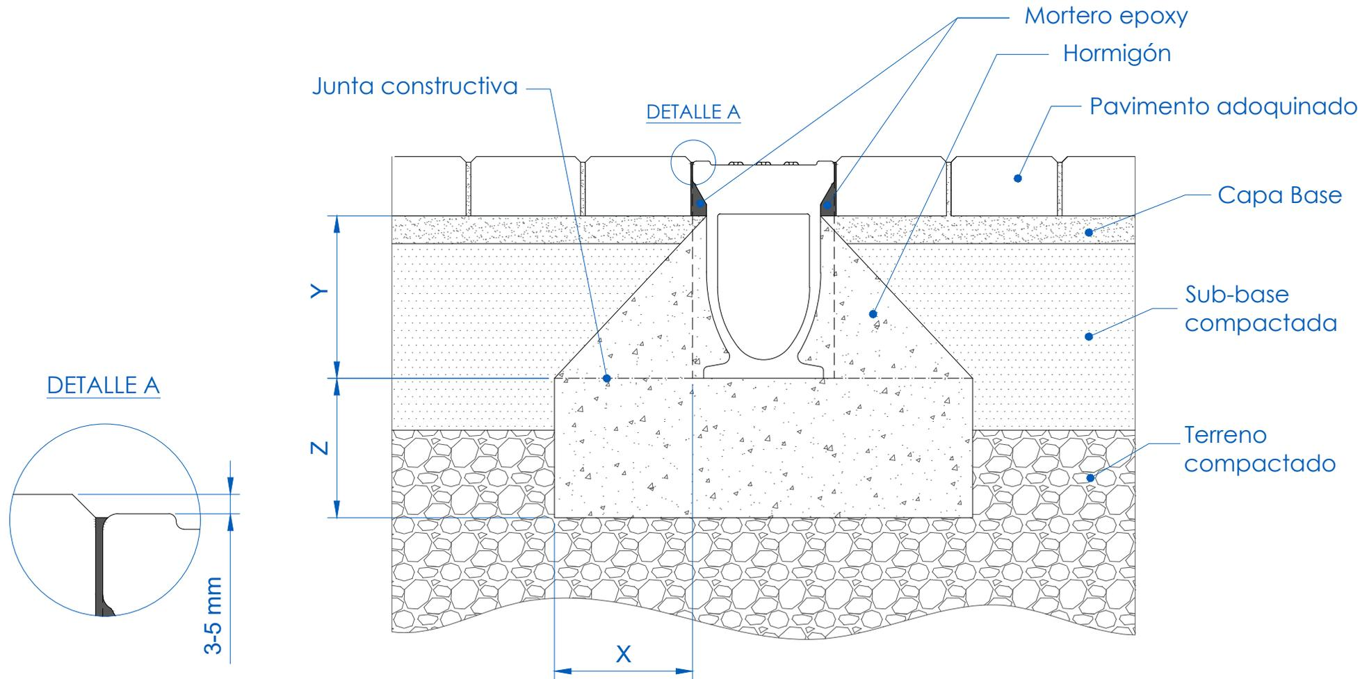
\* Si no existe un correcto compactado del terreno, realizar dado de hormigón hasta el nivel del pavimento.
