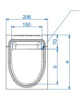
Ranura perimetral preformada para facilitar instalación de junta de sellado envolvente en 360°.
