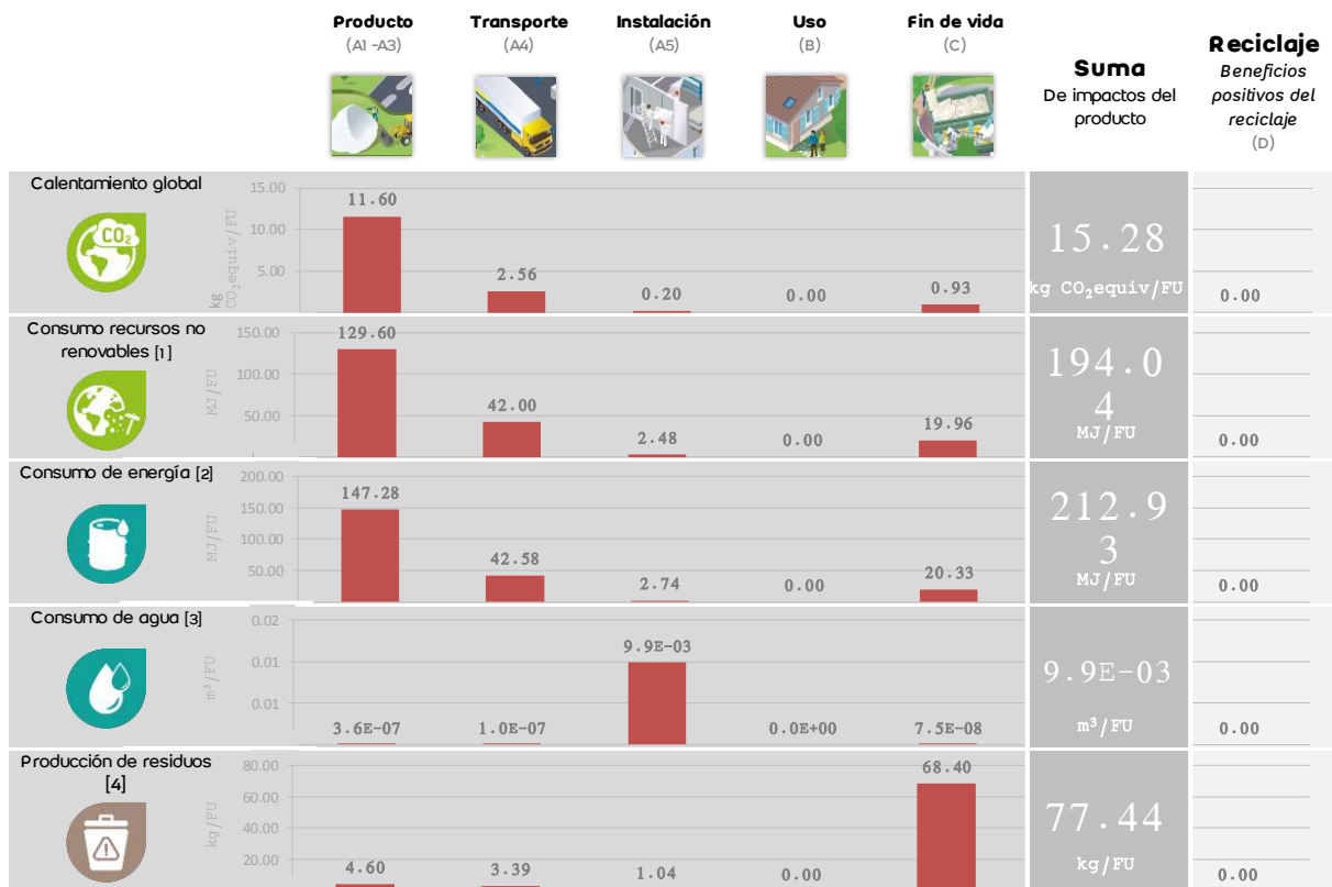
Figura 9: Suma de impactos ambientales totales del sistema weberfloor fluid (40 mm)
