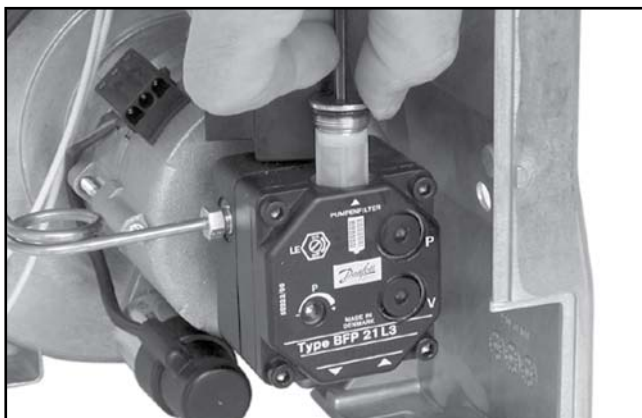
Figura 25 — Desmontaje del filtro de gasoil
