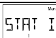
Mensaje de error (en caso de error en la conmutación inversa de 10 V a 0 V)
