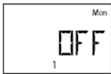
Salida de control desactivada
