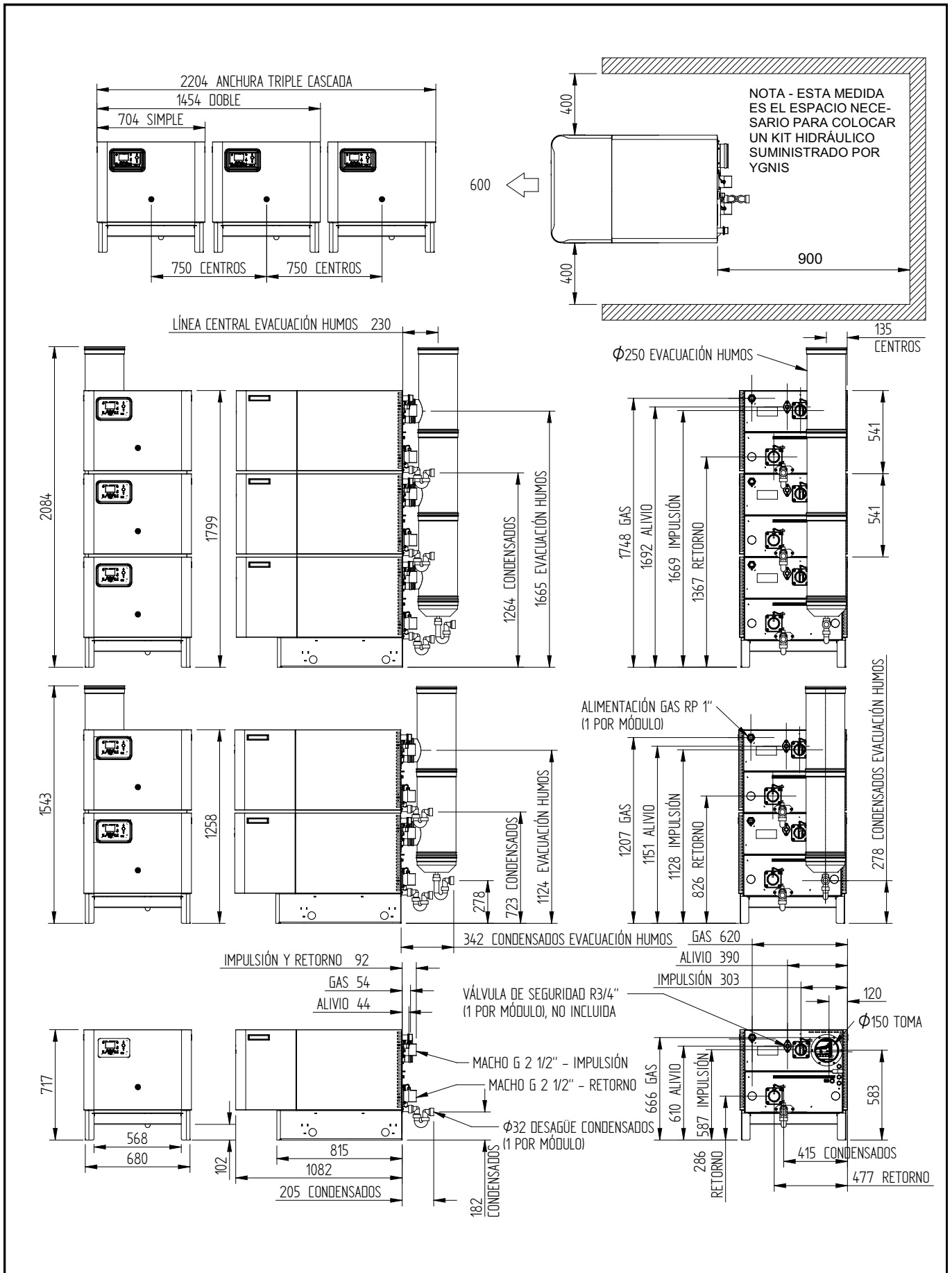
Figura 3.1.2 - Dimensiones y espacio libre para los modelos 150/200/250
